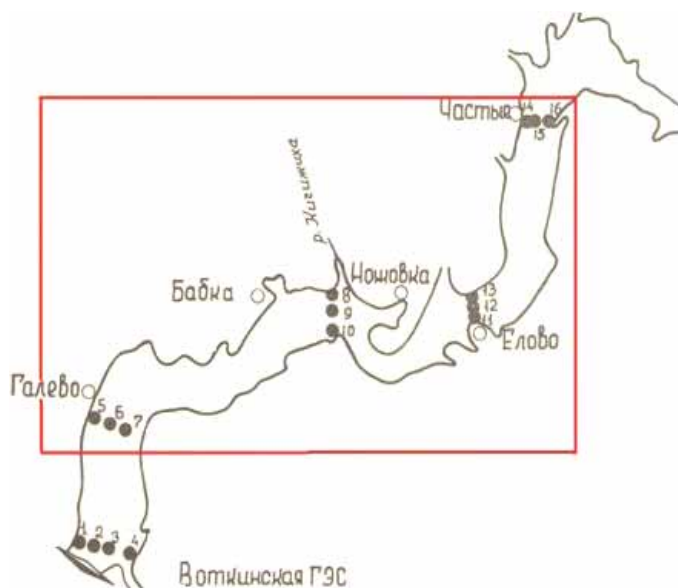
Рис. 1. Схема расположения скоростных вертикалей I района Воткинского водохранилища
