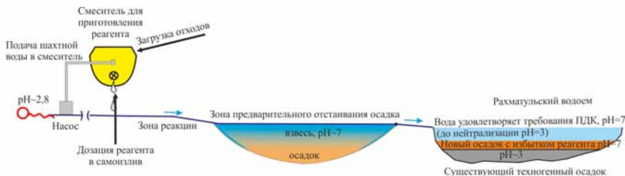
Рис. 4. Технологическая схема очистки кислых шахтных вод Кизеловского угольного бассейна отходами ОАО «Березниковский содовый завод» на примере шахты им. 40 лет Октября
